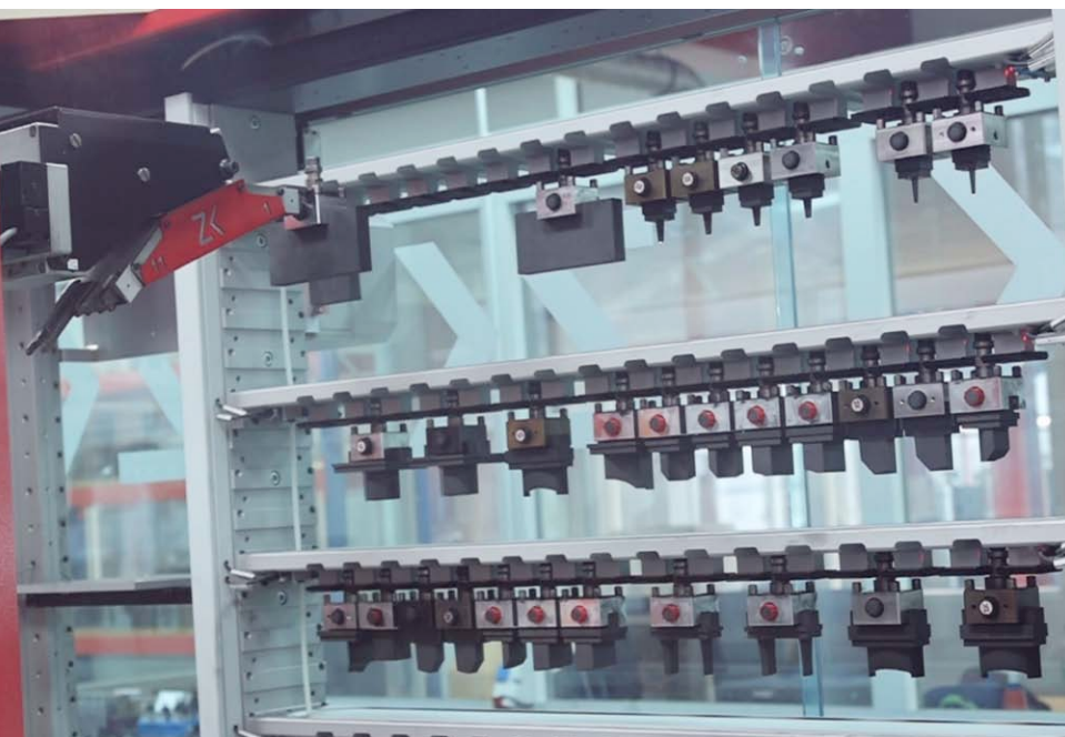
Automatisch wechselt das Chameleon eine Elektrode in die genius 1000 ein. Der Doppelgreifer sorgt für Effizienz – auf der anderen Seite des Greifers ist die alte Elektrode, die nach getaner Erodierarbeit zurück ins Regal gebracht wird.
