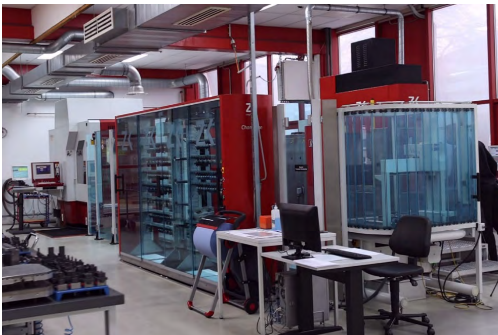
Die Automatisierung ermöglicht ein mannloses Arbeiten rund um die Uhr, auch übers Wochenende. Im Vordergrund an der Stirnseite der Anlage ist die Messmaschine Zeiss Vista positioniert.
