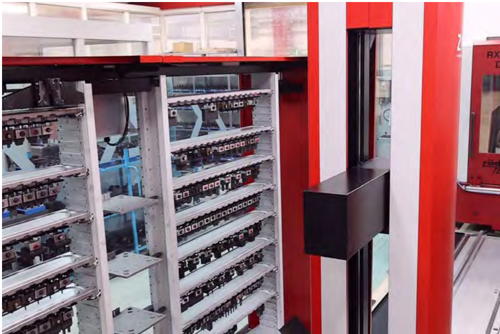
Das Chameleon von Zimmer & Kreim verbindet bei SD Formentechnik zwei genius -Senkerodieranlagen unterschiedlicher Größe mit einer Rödgers-HSC-Fräsmaschine zur Elektrodenbearbeitung und einer Messmaschine Zeiss Vista.
