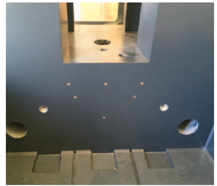
Neben den sehr guten mechanischen Eigenschaften ein weiterer Vorteil des Maschinengestells aus Mineralguss: Die Medienführung ist bereits optimal integriert.
